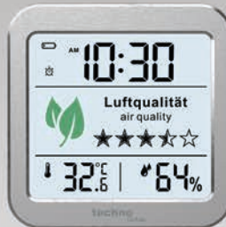
WL 1020 Luftgüte-Monitor Überwachung der Raumluftqualität Gelbe Beleuchtung = Lüftung empfohlen, Rote Beleuchtung = Lüftung dringend empfohlen, Messung über Mischgas(VOC)-Sensor, Hintergrundbeleuchtung, Innentemp., Quarzuhr, Alarm mit Snooze, USB-Kabel (inklusive) 82x82 mm
